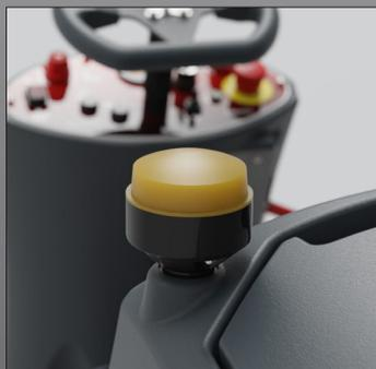
Dispositifs de sécurité embarqués : arrêt d'urgence, klaxon, clé de contact et feux de détresse.
