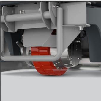
Le contrôleur de traction améliore la durabilité grâce à une fonction de démarrage/arrêt lent, une accélération / décélération en douceur et un ralentissement automatique dans les virages serrés.
